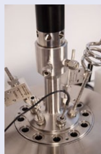
Cover plate and drive Deckelplatte und Antrieb
